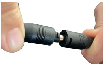
Anschluss des Netzteils an das LED-Streifen.
